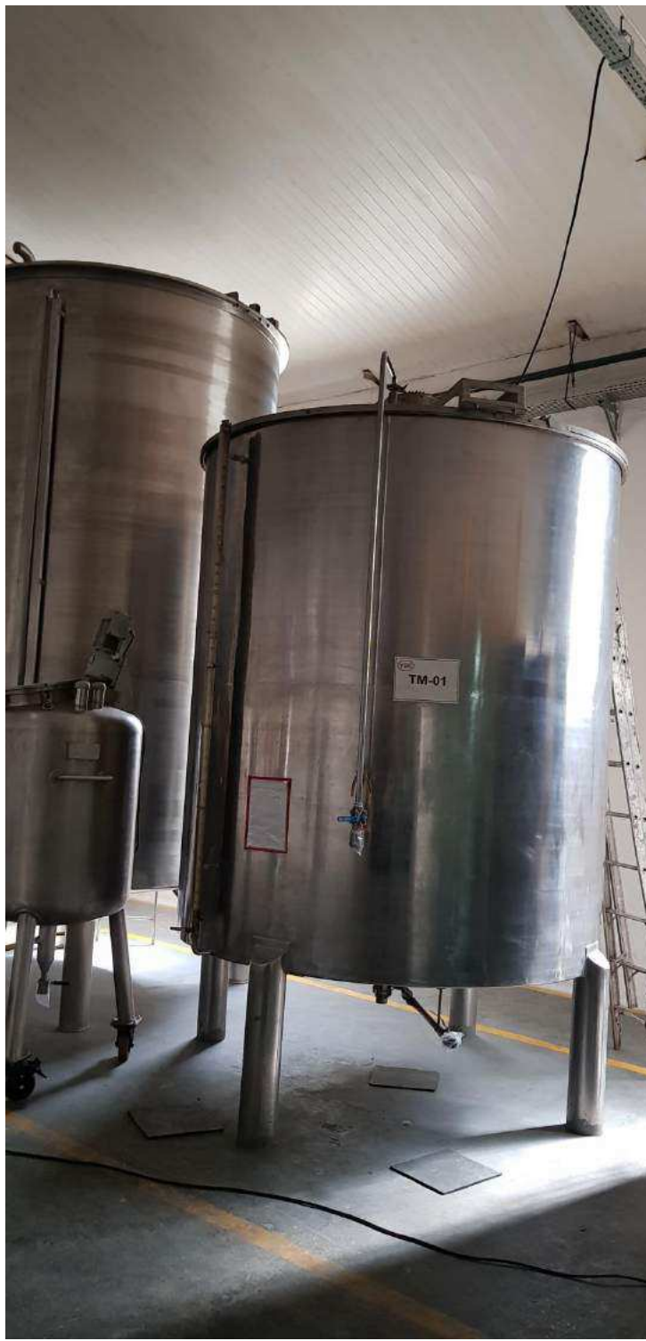
EQUIPAMENTO DE PREPARAÇÃO ÓLEO DE MENTA
